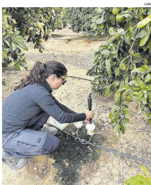
Medida de la humedad del suelo durante un ensayo.
